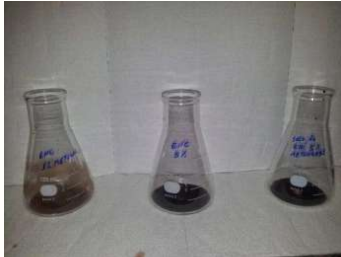
Figura 9 – Etapa de oxidação com \text{KMnO}_4 30g/l de \text{H}_3\text{PO}_4 no teste alternativo com três amostras testes: EHC contaminado com 1% (v/v) de metanol; EHC 5% (v/v) sem contaminação e; EHC 5% (v/v) contaminado com 0,05%(v/v) de metanol;
