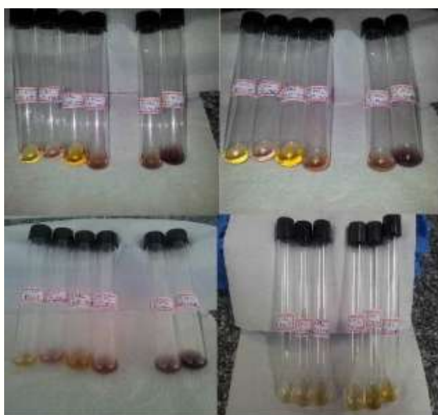
Figura 13 – Amostras em processo de teste colorimétrico. Amostras com cor violeta a púrpura estão não conforme.
