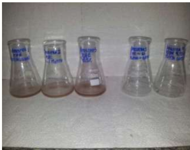
Figura 7 – Etapa de redução com \text{Na}_2\text{S}_2\text{O}_5 100g/l na reprodução da ISO 1388-7 para cinco amostras testes: EHC (testemunha); EHC contaminado com 1% (v/v) de metanol; EHC contaminado com 0,5% (v/v) de metanol; EHC 5% (v/v) contaminado com 0,05% (v/v) de metanol e; Etanol absoluto diluído a 4,95% (v/v) e contaminado com 0,05% de metanol;
