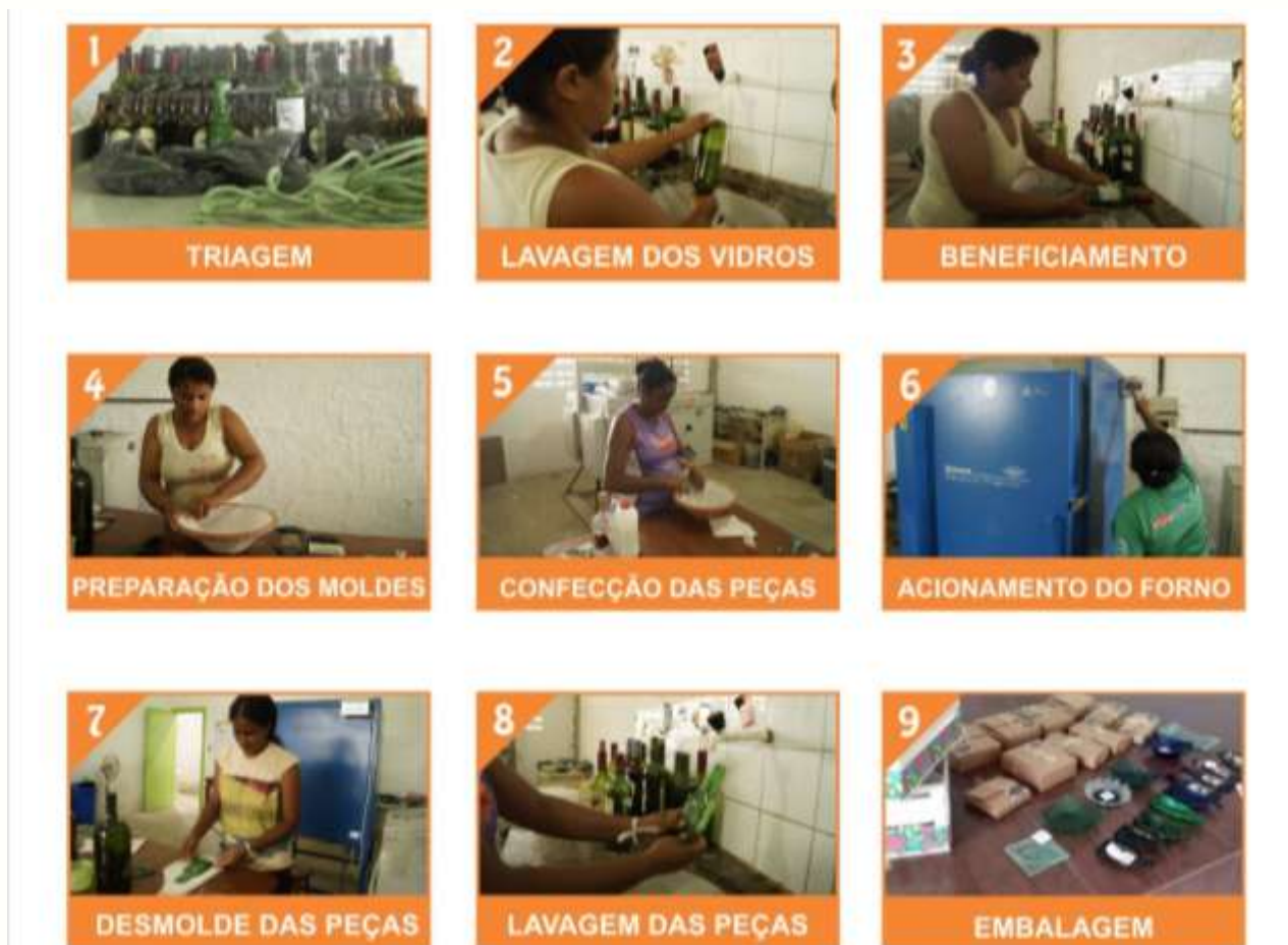
Figura 3 – Etapas de reciclagem de vidros para confecção de peças artesanais. Fonte: Pesquisa direta (2015).
