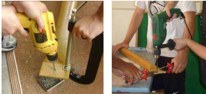
Figura 5: Prensagem das pontas do tubos e furação. Fonte: SALADO (2016).
