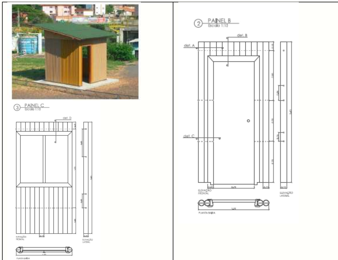
Figura 3: Acima esquerda - Célula teste com painéis em tubos de papelão. Direita – painel em tubos de papelão porta. Abaixo esquerda – painel em tubos de papelão janela. Fonte: Salado (2011).
